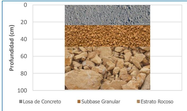
Figura 16. Espesores en las losas del Túnel 1.
