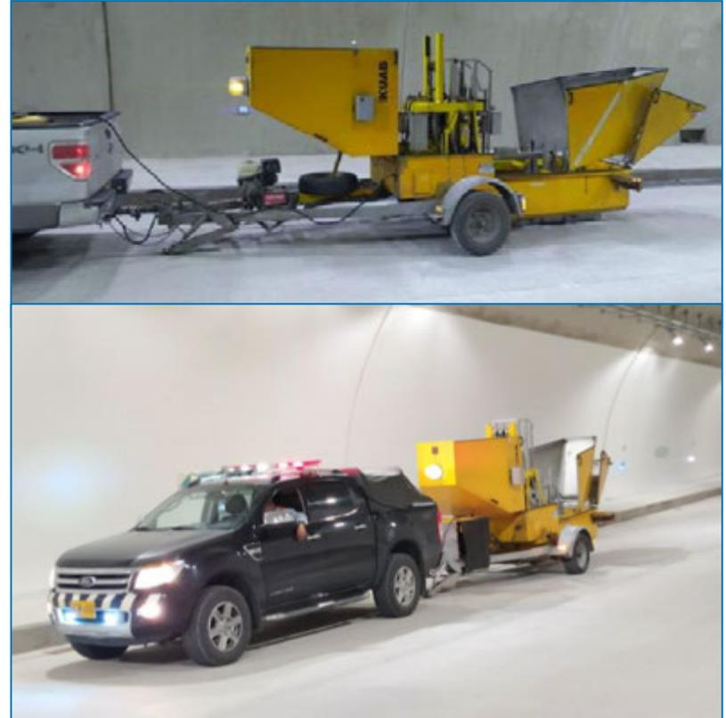
Figura 1. Medición de transferencia de carga en juntas de pavimento rígido con el equipo KUAB-50
